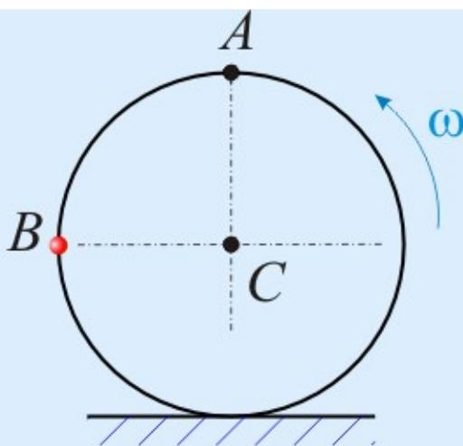
Определить скорость точки  $B$  колеса, совершающего качение без проскальзывания если скорость точки  $A$  составляет  $V_A=2\text{ м/с}$ .
