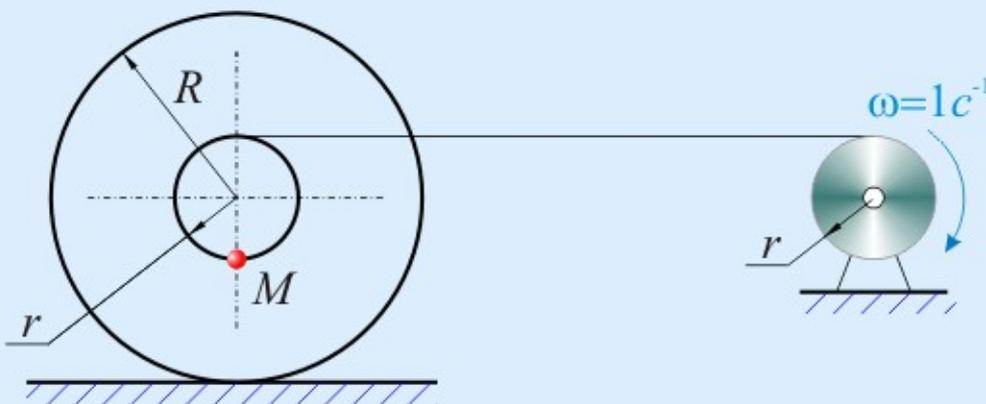
Угловая скорость барабана  $\omega = 1\text{ c}^{-1}$ . Определить окружную (линейную) скорость точки  $M$  ступенчатого катка, осуществляющего процесс качения без проскальзывания, если  $r = 0,1\text{ м}$ ,  $R = 0,3\text{ м}$ .
