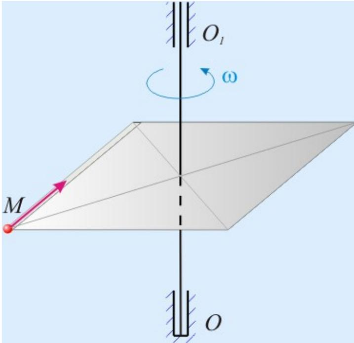
Квадратная пластина вращается вокруг оси  $OO_1$  с угловой скоростью  $\omega = 5 \text{ с}^{-1}$ . Вдоль стороны плиты движется точка  $M$  с постоянной скоростью  $V_1 = 4 \text{ м/с}$ . Определить абсолютную скорость точки  $M$  в указанном на рисунке положении, если сторона квадрата  $a = 6 \text{ м}$ .
