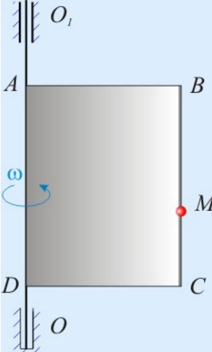
Пластина  $ABCD$  вращается вокруг оси  $OO_1$  с угловой скоростью  $\omega = 4 \text{ с}^{-1}$ .
